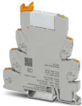
PLC-INTERFACE, composta da morsetto base PLC-BPT.../21 con connessione Push-in e relè in miniatura a innesto con contatto di potenza, per il montaggio su guida di supporto NS 35/7,5, 1 contatto di scambio, tens. di ingresso 12 V DC
