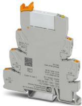
PLC-INTERFACE, composta da morsetto base PLC-BPT.../21 con connessione Push-in e relè in miniatura a innesto con contatto di potenza, per il montaggio su guida di supporto NS 35/7,5, 1 contatto di scambio, tens. di ingresso 48 V DC
