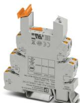
Morsetto base PLC da 14 mm per correnti permanenti elevate con connessione Push-in, senza equipagg. relè o relè a stato solido, per il montaggio su guida di montaggio, NS 35/7,5, 1 contatto di scambio tens. di ingr.: 230 V AC/DC
