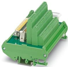
Modulo a 16 canali per moduli Honeywell C300. Il modulo viene gestito sul lato controllore mediante D-SUB da 37 poli oppure FLK da 50 poli. Sul lato campo è disponibile una connessione a vite. Larghezza modulo: 113 mm
