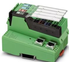
Inline, Accoppiatore bus, EtherNet/IP™, Connettore femmina RJ45, Ingressi digitali: 8, 24 V DC, tecnica di connessione: 3 conduttori, Uscite digitali: 4, 24 V DC, 500 mA, tecnica di connessione: 3 conduttori, velocità di trasmissione nel bus locale: 500 kBit/s / 2 MBit/s, grado di protezione: IP20, connettori Inline e cartellini di siglatura incl.
