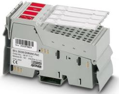
Inline, Morsetto a relè, Uscite relè: 4 (a potenziale zero), Contatto in chiusura, 24 V DC, 230 V AC, elevata corrente d'inserzione, velocità di trasmissione nel bus locale: 500 kBit/s, grado di protezione: IP20, connettori Inline e cartellini di siglatura incl.
