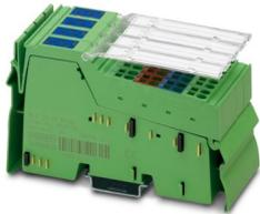
Inline, Morsetto ingresso digitale, Ingressi digitali: 16, 24 V DC, tecnica di connessione: 3 conduttori, velocità di trasmissione nel bus locale: 500 kBit/s, grado di protezione: IP20, connettori Inline e cartellini di siglatura incl.
