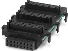
Connettore per guide di supporto, colore: nero, corrente nominale: 3 A (Corrente cumulativa max. 25 A), tensione di dimensionamento (III/2): 30 V, numero poli: 16, serie di prodotti: BC 53,6., passo: 2,54 mm, montaggio: Montaggio su guida DIN, bloccaggio: assente
