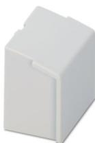
Custodia per guide DIN per l'impiego nei ripartitori di installazione a norma DIN 43880, Tappi ciechi per punti di collegamento inutilizzati (U22), larghezza: 35,6 mm, altezza: 29,78 mm, profondità: 22,35 mm, colore: grigio chiaro (simili RAL 7035)
