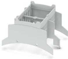
Custodia per guide DIN per l'impiego nei ripartitori di installazione a norma DIN 43880, Parte superiore custodia (U22) con feritoie di ventilazione, Profondità di incasso della tecnologia di connessione: 22,35 mm, larghezza: 71,6 mm, altezza: 89,7 mm, profondità: 54,85 mm, colore: grigio chiaro (simili RAL 7035)
