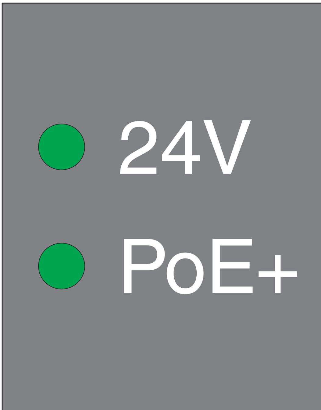
Indicatore di tensione di stato e di uscita di 24 V (verde)
