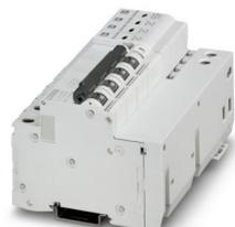
Combinazione di protezione contro le sovratensioni tipo 2 e prefusibile scaricatore, con monitoraggio dello scaricatore e del prefusibile, in abbinamento al contatto FM. Esecuzione: sistema a 5 conduttori (L1, L2, L3, N, PE), montaggio su guida di supporto NS 35
