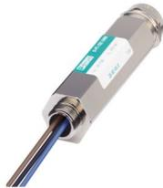
Protezione contro le sovratensioni nel modulo a vite IP67 per convertitore dei dati di misurazione, montaggio diretto mediante filettatura esterna 3/4" NPT, pressacavi per linea di segnale, circuito di protezione a due stadi. Compatibile con HART. Utilizzabile in circuiti di sicurezza fino a SIL 3.
