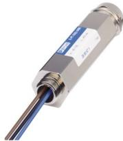
Protezione contro le sovratensioni nel modulo a vite IP67 per convertitore di dati di misurazione in circuiti elettrici a sicurezza intrinseca, montaggio diretto mediante filettatura esterna 3/4" NPT, pressacavi per linea di segnale, circuito di protezione a due stadi. Compatibile con HART. Utilizzabile in circuiti di sicurezza fino a SIL 3.
