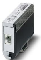
Protezione contro le sovratens. secondo Classe E<sub>A</sub> (CAT6<sub>A</sub>), per Gigabit-Ethernet (fino a 10 GBit/s), Token Ring, FDDI/CDDI, ISDN, DS1. Adatta per Power over Ethernet (PoE++ / 4PPoE) "Mode A" e "Mode B". Adattatore RJ45 con linea di messa a terra separata e piedino di fissaggio per la messa a terra per guide di supporto NS 35.
