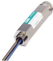
Protezione contro le sovratensioni nel modulo a vite IP67 per convertitore dei dati di misurazione, montaggio diretto mediante filettatura esterna M20 x 1,5, pressacavi per linea di segnale, circuito di protezione a due stadi. Compatibile con HART. Utilizzabile in circuiti di sicurezza fino a SIL 3.
