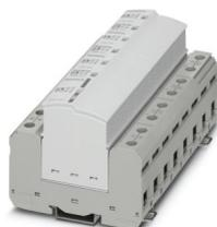
Combinazione di scaricatori di sovratensioni e di corrente atmosferica a innesto, secondo tipo 1+2 / classe I+II, per reti di alimentazione trifase con N e PE separati (sistema a 5 conduttori: L1, L2, L3, N, PE), senza contatto di segnalazione remota.
