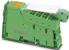
Inline, Modulo di comunicazione, interfaccia RS-232: 1, Comunicazione via dati di processo, velocità di trasmissione nel bus locale: 500 kBit/s, grado di protezione: IP20, connettori Inline e cartellini di siglatura incl.
