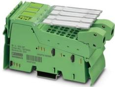
Inline, Morsetto di rilevamento estensimetro, velocità di trasmissione nel bus locale: 500 kBit/s, 2 ingressi rapidi, Tecnologia di connessione a 4 e 6 conduttori, grado di protezione: IP20, connettori Inline e cartellini di siglatura incl.
