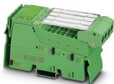
Inline, Morsetto ingresso analogico, Ingressi analogici: 4, 0 V ... 5 V, -5 V ... 5 V, 0 V ... 10 V, -10 V ... 10 V, 0 mA ... 20 mA, 4 mA ... 20 mA, -20 mA ... 20 mA, tecnica di connessione: 2, 3, 4 conduttori, velocità di trasmissione nel bus locale: 500 kBit/s, grado di protezione: IP20, connettori Inline e cartellini di siglatura incl.
