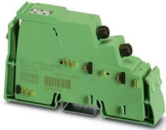
Inline, morsetto di diramazione, INTERBUS, connettore schermato F-SMA, con derivazione di bus remoto, velocità di trasmissione nel bus locale: 2 MBit/s, grado di protezione: IP20, senza accessori
