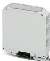
Custodie per guide DIN, Custodia completa con piedino di fissaggio in metallo, design piatto, senza feritoia di ventilazione, larghezza: 22,6 mm, altezza: 85 mm, profondità: 91,15 mm, colore: grigio chiaro (simili RAL 7035), collegamento trasversale: Connettore per guide di supporto (opzionale), n. poli connettore trasversale: 5
