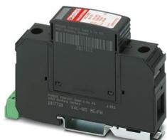
Scaricatore di sovratensioni costituito da elemento base con contatto FM e spina di sicurezza con varistore di potenza, per montaggio su NS 35/7,5, 1 canale
