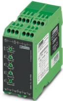
Modulo di controllo per il monitoraggio di tensioni trifase da 350...650 V AC, sottotensione, window, sequenza fasi, mancanza fase, asimmetria, tensione di alimentazione a scelta mediante modulo Power, 2 contatti di scambio
