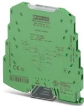
Isolatore galvanico a 3 vie, per la separazione galvanica di segnali analogici, connessione a vite, ingresso: 0(4) mA ... 20 mA, uscita: 0(4) mA ... 20 mA
