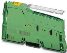
Inline, Morsetto uscita digitale, Uscite analogiche: 2, 0 V ... 10 V, -10 V ... 10 V, tecnica di connessione: 2 conduttori, velocità di trasmissione nel bus locale: 500 kBit/s, grado di protezione: IP20, connettore Inline e cartellini di siglatura incl.
