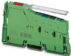
Inline, Morsetto uscita digitale, Uscite digitali: 4, 24 V DC, tecnica di connessione: 3 conduttori, velocità di trasmissione nel bus locale: 500 kBit/s, grado di protezione: IP20, connettore Inline e cartellini di siglatura incl.
