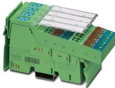
Inline, Morsetto ingresso digitale, Ingressi digitali: 16 (NPN), 24 V DC, tecnica di connessione: 3 conduttori, velocità di trasmissione nel bus locale: 500 kBit/s, grado di protezione: IP20, connettori Inline e cartellini di siglatura incl.
