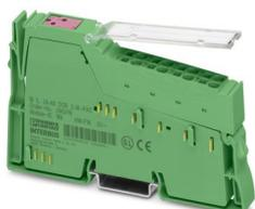
Inline, Morsetto a relè, Uscite relè: 2 (a potenziale zero), Contatto di scambio, 24 V AC, 48 V DC, per l'avviamento di carichi ohmici, velocità di trasmissione nel bus locale: 500 kBit/s, grado di protezione: IP20, connettore Inline e cartellini di siglatura incl.
