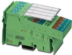
Inline, Morsetto ingresso digitale, Ingressi digitali: 16, 24 V DC, tecnica di connessione: 3 conduttori, velocità di trasmissione nel bus locale: 500 kBit/s, grado di protezione: IP20, connettori Inline e cartellini di siglatura incl., connettori numerati singolarmente
