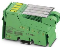
Inline, Morsetto uscita digitale, Uscite analogiche: 2, 0 V ... 10 V, 0 mA ... 20 mA, 4 mA ... 20 mA, tecnica di connessione: 2 conduttori, velocità di trasmissione nel bus locale: 2 MBit/s, grado di protezione: IP20, connettori Inline e cartellini di siglatura incl.
