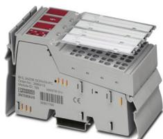
Inline, Morsetto a relè, Uscite relè: 4 (a potenziale zero), Contatto di scambio, 24 V DC, 230 V AC, per la commutazione di carichi induttivi e capacitivi, velocità di trasmissione nel bus locale: 500 kBit/s, grado di protezione: IP20, connettori Inline e cartellini di siglatura incl.
