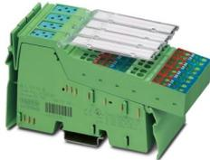
Inline, Morsetto ingresso digitale, Ingressi digitali: 16, 24 V DC, tecnica di connessione: 3 conduttori, velocità di trasmissione nel bus locale: 2 MBit/s, grado di protezione: IP20, connettori Inline e cartellini di siglatura incl.
