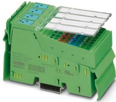
Inline, Morsetto ingresso digitale, Ingressi digitali: 8, 24 V DC, tecnica di connessione: 4 conduttori, velocità di trasmissione nel bus locale: 2 MBit/s, grado di protezione: IP20, connettori Inline e cartellini di siglatura incl.
