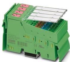
Inline, Morsetto uscita digitale, Uscite digitali: 8, 24 V DC, tecnica di connessione: 4 conduttori, velocità di trasmissione nel bus locale: 2 MBit/s, grado di protezione: IP20, connettori Inline e cartellini di siglatura incl.
