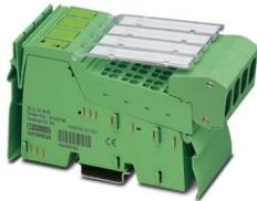
Inline, Morsetto ingresso analogico, Ingressi analogici: 8, 0 mA ... 20 mA, 4 mA ... 20 mA, -20 mA ... 20 mA, 0 mA ... 40 mA, -40 mA ... 40 mA, tecnica di connessione: 2/3 conduttori, velocità di trasmissione nel bus locale: 500 kBit/s, alimentazione sensori integrata, grado di protezione: IP20, connettori Inline e cartellini di siglatura incl.
