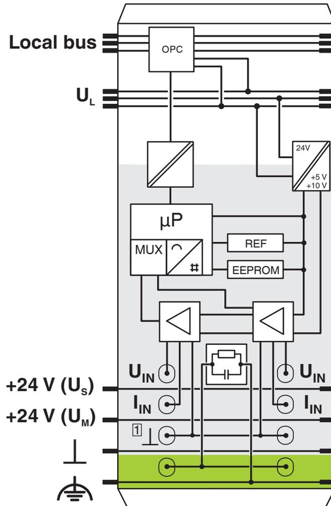
Circuito interno dei punti di connessione
