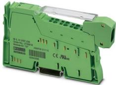
Inline, Morsetto ingresso analogico, Ingressi analogici: 2, 0 V ... 10 V, -10 V ... 10 V, 0 mA ... 20 mA, 4 mA ... 20 mA, -20 mA ... 20 mA, tecnica di connessione: 2 conduttori, velocità di trasmissione nel bus locale: 500 kBit/s, Frequenza limite di 3 dB a 230 Hz, grado di protezione: IP20, connettore Inline e cartellini di siglatura incl.
