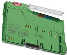
Inline, Morsetto uscita digitale, Uscite digitali: 2 (NPN), 24 V DC, tecnica di connessione: 4 conduttori, velocità di trasmissione nel bus locale: 500 kBit/s, grado di protezione: IP20, connettore Inline e cartellini di siglatura incl.
