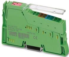
Inline, Morsetto uscita digitale, Uscite digitali: 2, 24 V DC, tecnica di connessione: 4 conduttori, velocità di trasmissione nel bus locale: 500 kBit/s, grado di protezione: IP20, connettore Inline e cartellini di siglatura incl.
