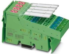
Inline, Morsetto uscita digitale, Uscite digitali: 16, 24 V DC, 500 mA, tecnica di connessione: 3 conduttori, velocità di trasmissione nel bus locale: 500 kBit/s, grado di protezione: IP20, connettori Inline e cartellini di siglatura incl.
