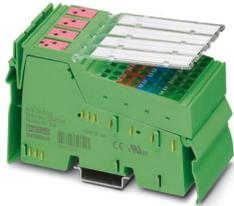
Inline, Morsetto uscita digitale, Uscite digitali: 8, 24 V DC, tecnica di connessione: 4 conduttori, velocità di trasmissione nel bus locale: 500 kBit/s, grado di protezione: IP20, connettori Inline e cartellini di siglatura incl.
