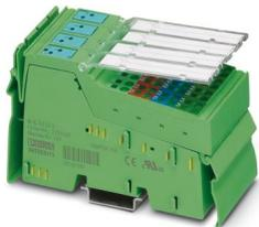
Inline, Morsetto ingresso digitale, Ingressi digitali: 8, 24 V DC, tecnica di connessione: 4 conduttori, velocità di trasmissione nel bus locale: 500 kBit/s, grado di protezione: IP20, connettori Inline e cartellini di siglatura incl.
