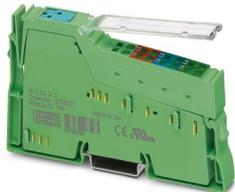
Inline, Morsetto ingresso digitale, Ingressi digitali: 2, 24 V DC, tecnica di connessione: 4 conduttori, velocità di trasmissione nel bus locale: 500 kBit/s, grado di protezione: IP20, connettore Inline e cartellini di siglatura incl.
