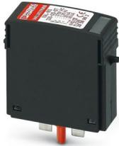
Scaricatore di sovratensioni tipo 2 con varistore di potenza per elemento base VAL-MS, controllato termicamente, segnalazione ottica di guasto. Esecuzione: 230 V AC
