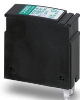
Spine di protezione con circuito di protezione senza correnti di dispersione per due segnali a potenziale di terra zero. Collegamento in serie costituito da varistore e scaricatore di sovratensioni a gas tra i fili di segnali e terra.
