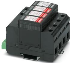
Scaricatori di sovratensioni costituiti da un elemento base con contatto FM e spine di protezione, per montaggio su NS 35/7.5, tensione nominale: 320 V AC, circuito 3 + 1
