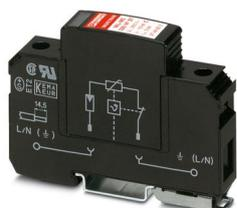
Scaricatore di sovratensioni costituito da elemento base e spina di protezione con collegamento in serie da varistore e spinterometro a gas, per montaggio su NS 35/7,5, tensione nominale: 230 V AC, a 1 canale
