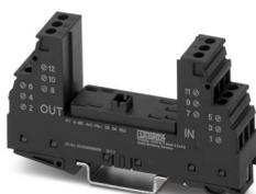
Elemento base per la spina di protezione PT con circuito di protezione per un circuito di segnale a quattro conduttori a potenziale di terra zero, ponticello tra i collegamenti 3-4 (GND) e 9-10, montaggio su NS 35/7,5 e NS 35/15, spessore custodia: 17,5 mm
