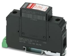
Scaricatore di sovratensioni costituito da elemento base con contatto FM e spina di sicurezza con varistore di potenza, per montaggio su NS 35/7.5, tensione nominale: 230 V AC, a 1 canale
