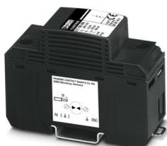
Scaricatori B tipo 1 / classe I (scaricatori di corrente atmosferica) con spinterometro a corrente cumulativa incapsulato N-PE, 1 canale. Larghezza custodia: 35 mm (2TE)
